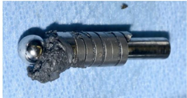
**Fig. 5 - Estesa metallosi del dispositivo (da [15])**
